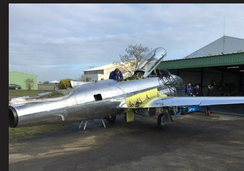
*Assemblage du cône arrière de fuselage*
