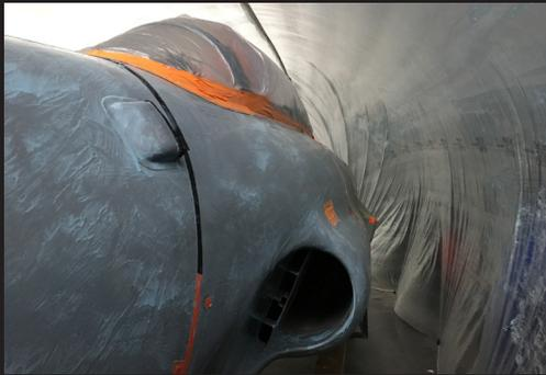
Décapage chimique du fuselage
