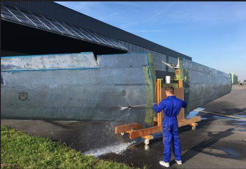
*Processus de décapage des éléments de voilure*
