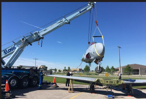
Désassemblage du fuselage et de l'aile
