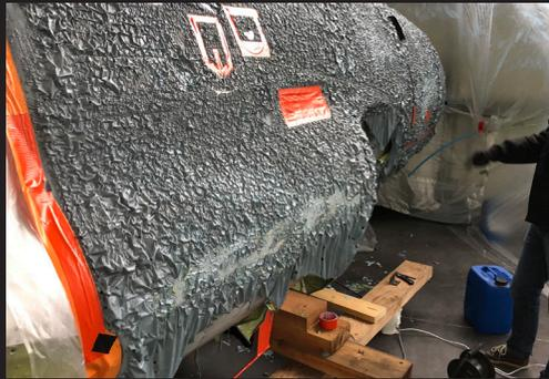
Décapage chimique du fuselage
